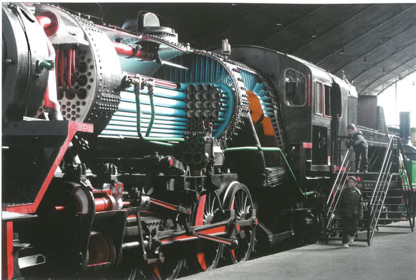
Locomotora 141-F 2416 Mikado seccionada. Debajo, maqueta en la Sala de Infraestructuras y camioneta auxiliar para trabajos ferroviarios.
