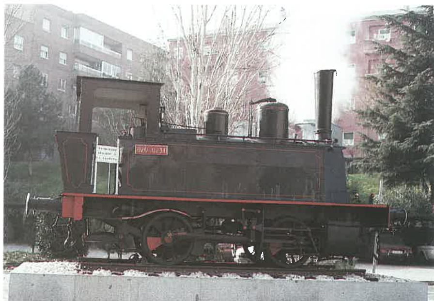
▲ Locomotora núm 020-0231, con número 601 de la antigua Compañía MZA, expuesta en la entrada al Museo de Delicias. Esta clase de máquinas de vapor fue muy utilizada en los servicios de maniobras de las grandes estaciones.
